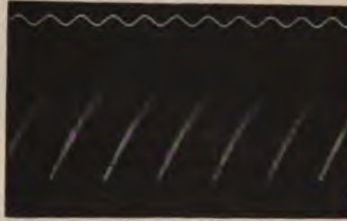
Abb. 286b. Primärer Strom eines Funkeninduktors bei elektrolytischem Unterbrecher.
